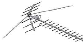
19. Устанавливать наружную антенну необходимо на максимально возможной высоте и разворачивать в сторону передающей станции. При монтаже нужно исключить возможные экранирующие поверхности поблизости – они будут создавать помехи и влиять на качество приема. Например, нельзя вешать антенну под козырьком металлической крыши и пр.
