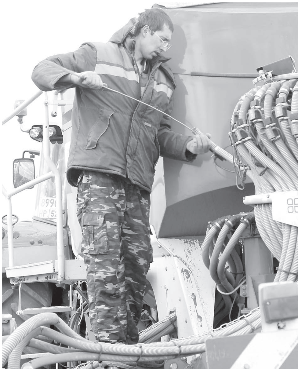
После получения сигнала от бортового компьютера о засорившихся сошниках механизатор Ю.Е. Попов проводит чистку элементов посевного комплекса.
